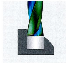
Anbohren runde Oberfläche
