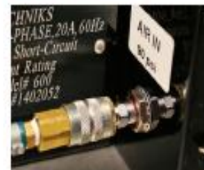
4. Normal Druck- und Temperatur Lufteinlass Rückseite
